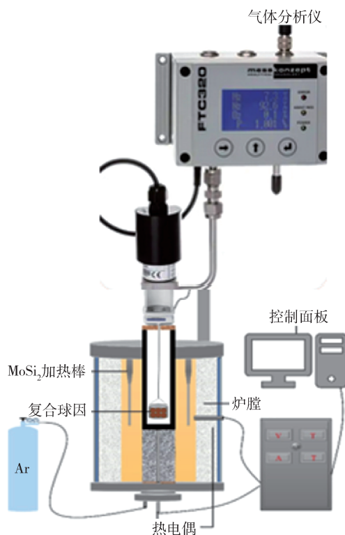
图1 管式炉试验装置图
