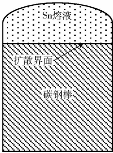
图 1 锡原子向碳钢表面的扩散
