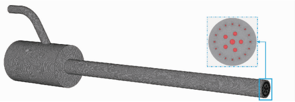
图4 计算域网格示意图
