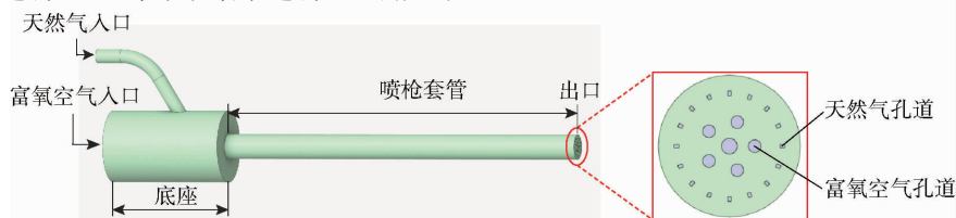
图2 喷枪与底座装配后外形结构图
