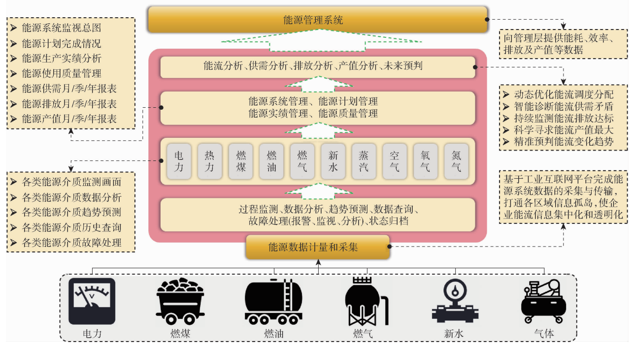
图3 冶金能源管理系统运行架构
