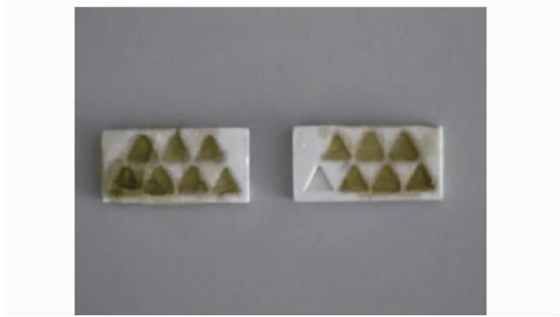
图 9 反应结束后熔融的 CaO 渣滴
