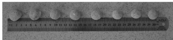
图 3 用于热爆试验的 \text{CaCO}_3 + \text{CaO} 球体
