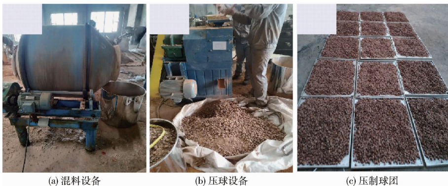
图4 高铁赤泥制球团过程
