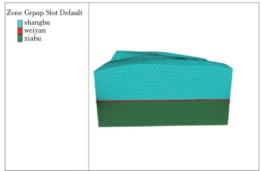
图3 河边采空区数值计算模型
